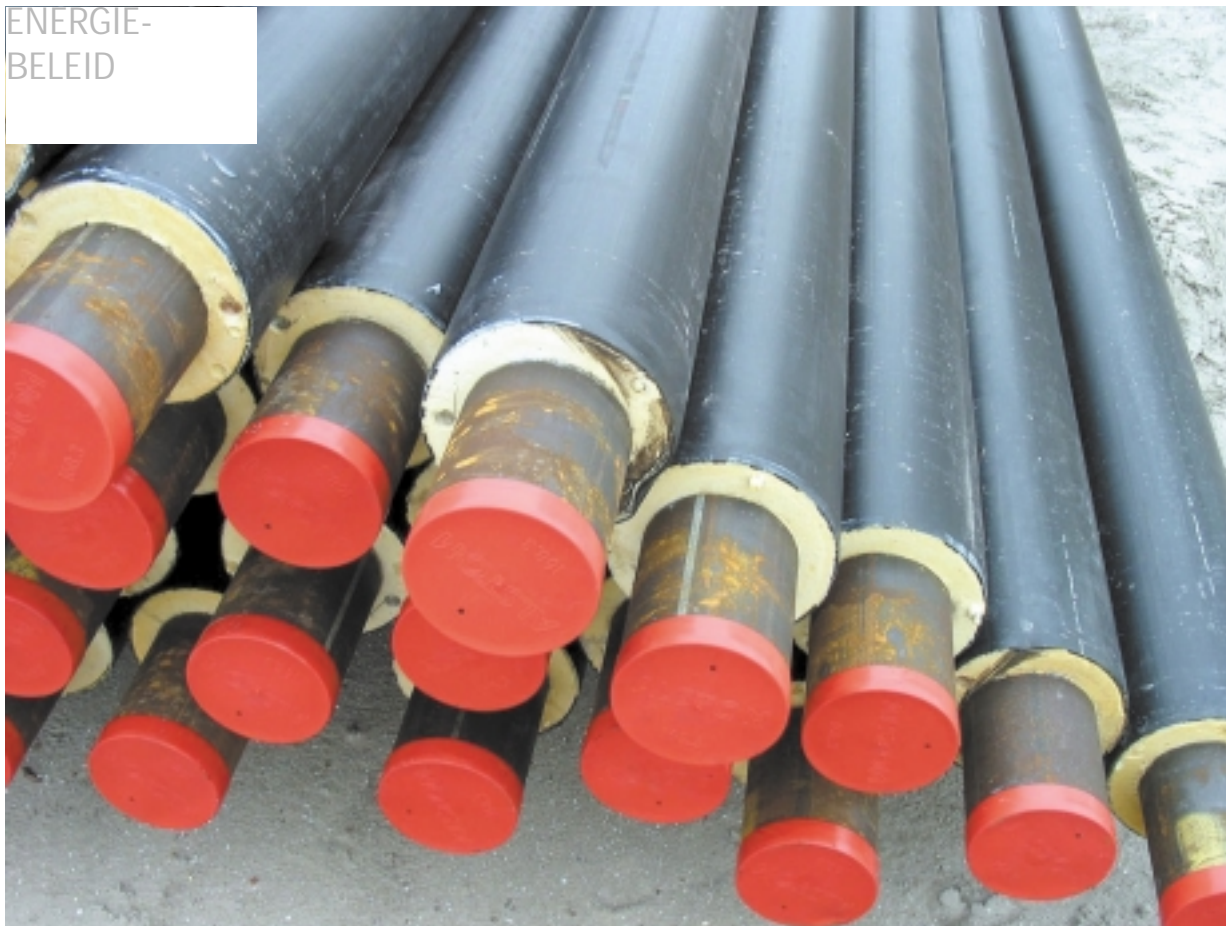
Buizen voor stadsverwarming
